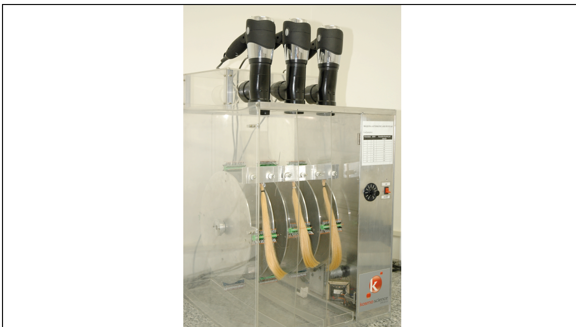
Figura 02: Máquina automática de pentear de três compartimentos, equipada com escovas e secadores NKS® de 1200 W
